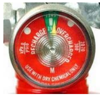
รูปที่ 3 Pressure Gauge ถังดับเพลิงที่แรงดันปกติ
